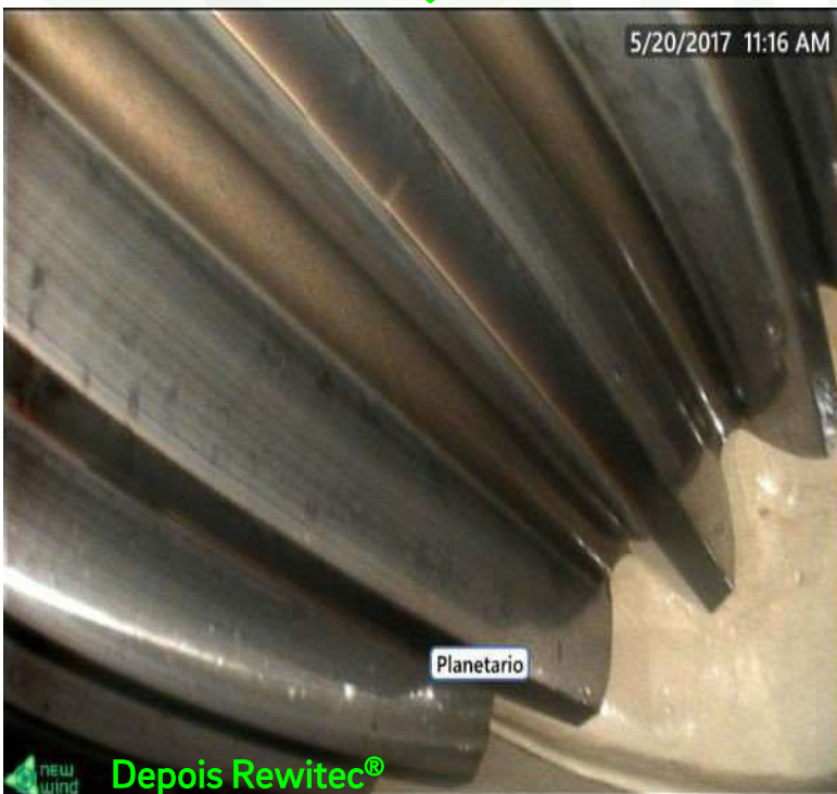
Planet Gear depois do tratamento com Rewitec®
