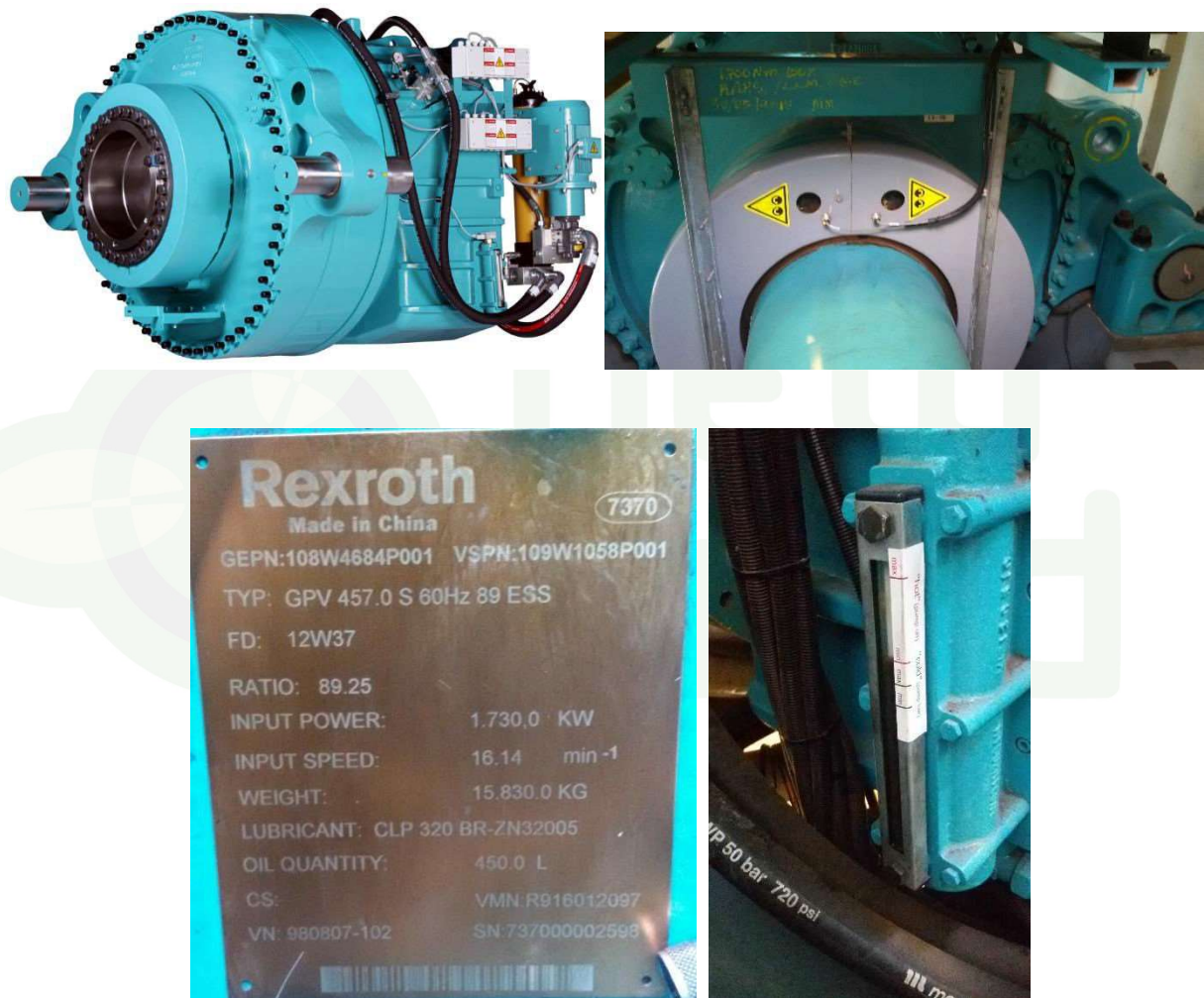
Figura 2 – Foto da gearbox, placa de identificação e nível de óleo
